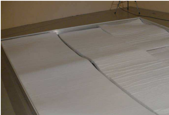
Bild 1: Rahmenaufbau mit Befestigungsprofil und Dämmstoffeinlage
